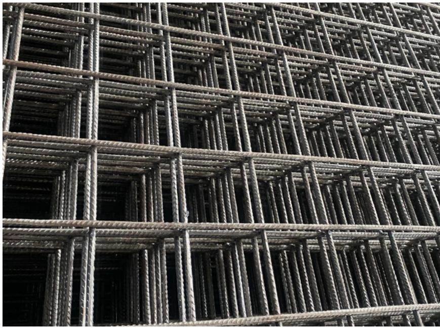
备料钢筋在加工前应洁净、无损伤，油渍、漆污和铁锈等在使用前处理干净。施工中如供应的钢筋品种和规格与设计图纸要求不符时，可以进行代换。但代换时，必须充分了解设计意图和代换钢材的性能，严格遵守规范的各项规定。对抗裂性要求高的构件，不宜用光面钢筋代换变形钢筋，钢筋代换时不宜改变构件中的有效高度，钢筋代换应遵循规范要求并征得设计同意；代换后的钢筋用量不宜大于原设计用量的5%，亦不低于2%，且应满足规范规定的较小钢筋直径、根数、
